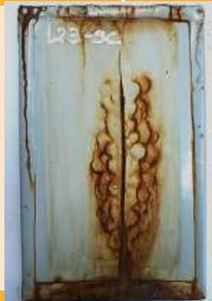
**Sistema com aditivação de 15 % de microcápsulas contendo éster de epóxi na primeira camada**
